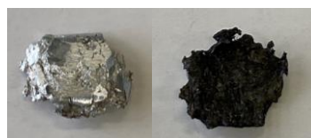
図4 銅を0.30%混ぜた亜鉛
