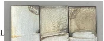
Figure 4 実験 4-1 温度を 30°C~50°C に変更時の陰極の様子 30°C (左) 40°C (中央) 50°C (右)
