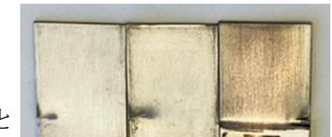
Figure 5 実験 4-2 電圧を 3V~9V に変更時の陰極の様子 3V (左) 5V (中央) 7V (右)
