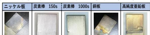
Figure 2 実験 2 陽極及び陰極変更時の陰極の様子
