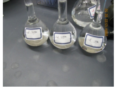
(左:試料を原子吸光分析装置でガス化させている様子。) (右:検量線を作成するためのCd標準溶液(1~4ppm)を作成。)
