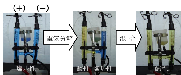
図2 炭素棒を用いた硫酸ナトリウム水溶液の電気分解 水酸化ナトリウム水溶液を数滴滴下している。
