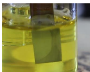
図4 一部だけが反応した鉄板
